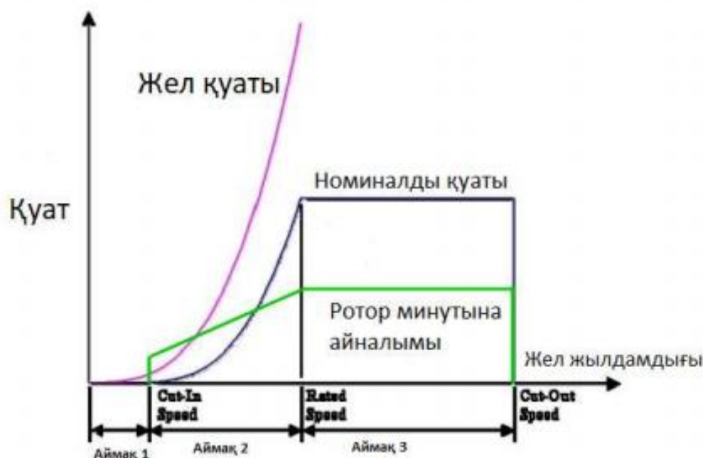
9 – сурет - Жел генератор қуатының жел жылдамдығына тәуелділік графигі
